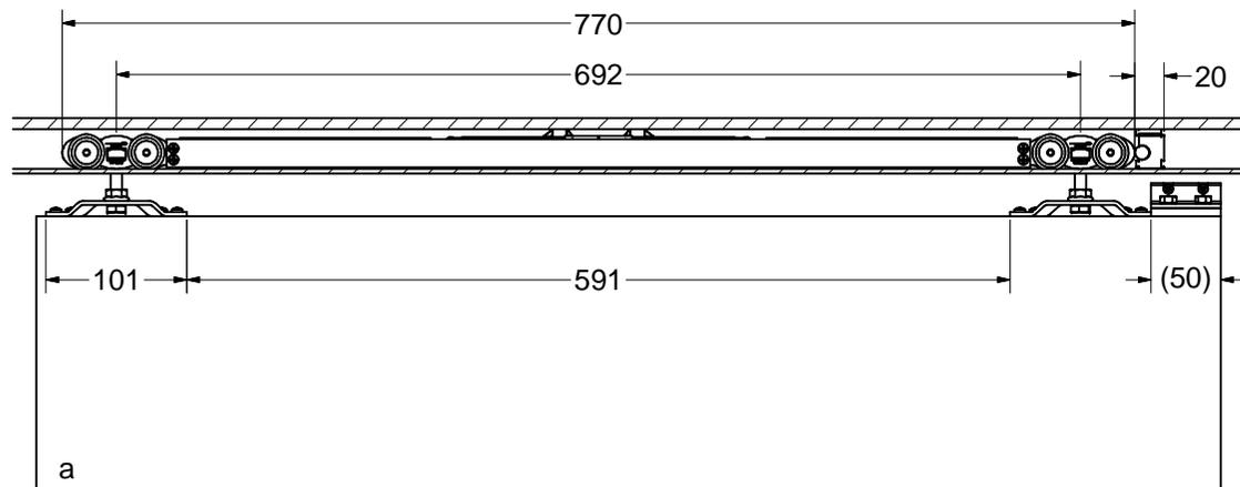
ein- oder beidseitig gedämpft / one- or both way damped
